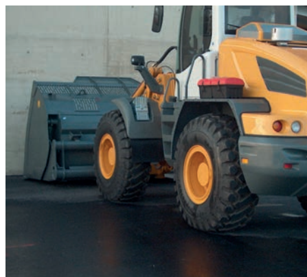
Radlader mit hoher Spezialschaufel – dadurch stark eingeschränkte Sicht nach vorn – und montierter Kamera mit Funkanbindung.
