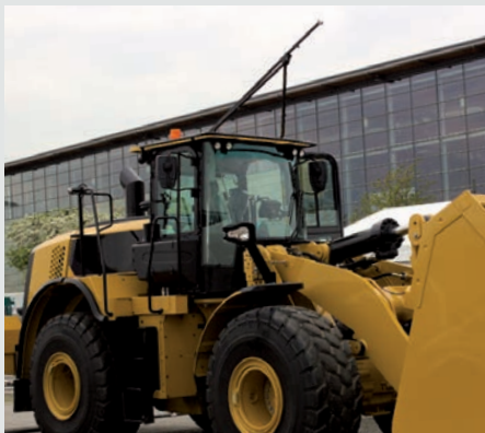
Radlader, kompletter Anbau von 4 Kameras: 360°-Bildarstellung aus der Vogelperspektive.
